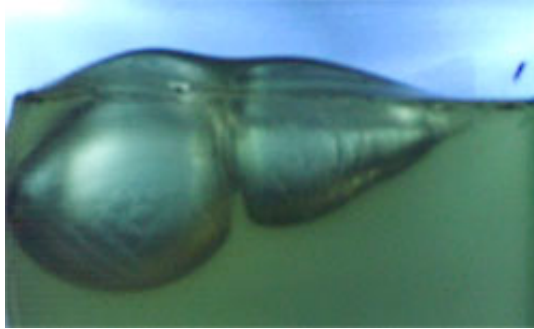
Tir d'un projectile de 5,45 x 39 mm dans de la gélatine à 10 %. Distance de tir 10 m. Le projectile ressort intact après bascule.
